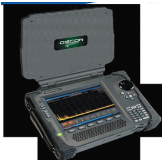
带有内置天线和分析软件 全集成频谱分析仪系统
